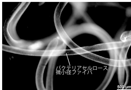
図 1 作製したバクテリアセルロース微小径ファイバの顕微鏡写真
