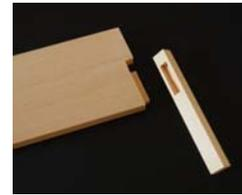
A: 正面上部の板と側板(前方)の接合
