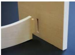
C : (4)下部の四方枠と(5)床下の棧の接合
