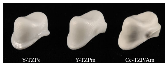
図2 作製した各種ジルコニアセラミッククラウンフレームワーク
