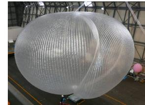
図6 座屈するローブパンキン型気球。
