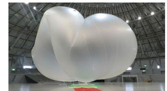
図2 座屈して変形しながら破壊する気球。
