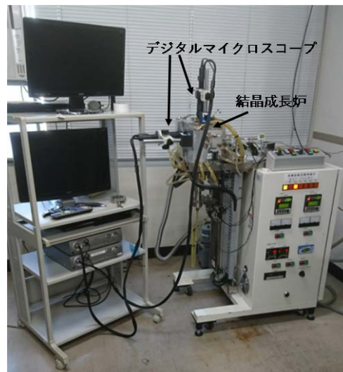
図2 新規に導入したその場観察装置
