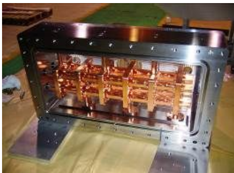
加速空洞内部 (銅メッキ前)
