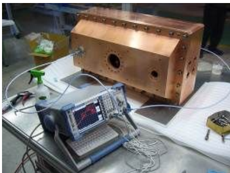
低電力試験 (銅メッキ後)
