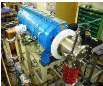
図 1 若手研究 (A) により開発に成功した 2 ビーム型 IH-RFQ 線形加速器
