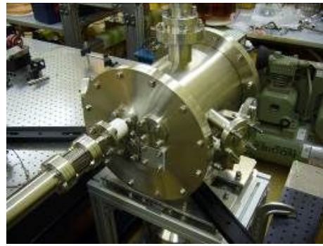
図 8 4 ビーム型レーザーイオン源
