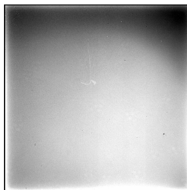
図6 1280×1280 (15 \mu\text{m} 画素) InGaAs 素子の画像例 不良画素は非常に少ない
