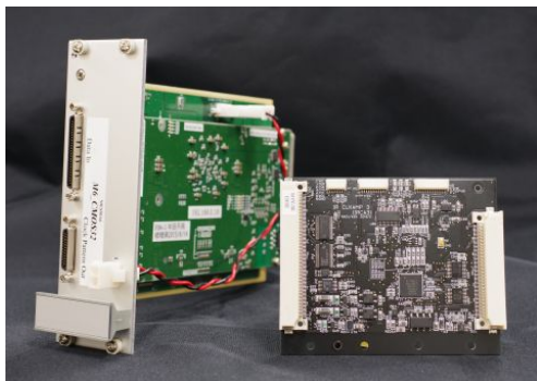
図8 1280×1280 素子のモザイクカメラ 駆動を想定した試作エレクトロニクス (左)バックエンド(右)フロントエンド
