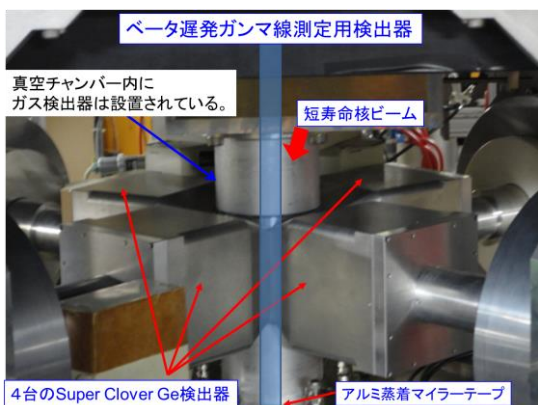
図 5 : 開発したベータ遅発ガンマ線核分光用の検出器の写真。上記のガス検出器の周りにガンマ線測定用のスーパークローバーGe検出器を 4 台配置している。
