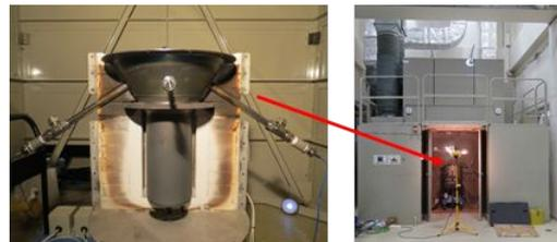
図 6 30kW<sub>th</sub> 反応器と大型サンシミュレータによる試験
