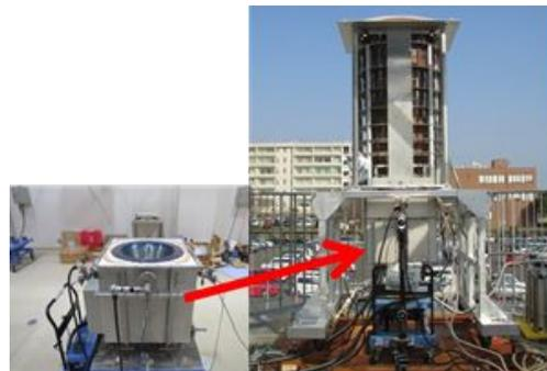
図 7 40kW<sub>th</sub> 反応器と宮崎ビームダウン太陽集光システムによる試験
