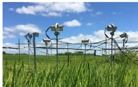
図 1. FACE リング内に設置された T-FACE 装置 (2016 年度)
