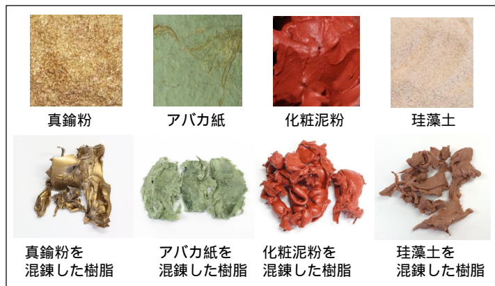
図1 樹脂に混練したフィラーの一例（上側）と混練後の樹脂の一例（下側）
