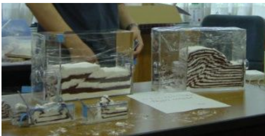
図1: 既存の断層実験の例。小麦粉とココアを使用した水平成層の側面から押し板で断層の発生を観察する。断層運動と地震の関係づけが困難。
