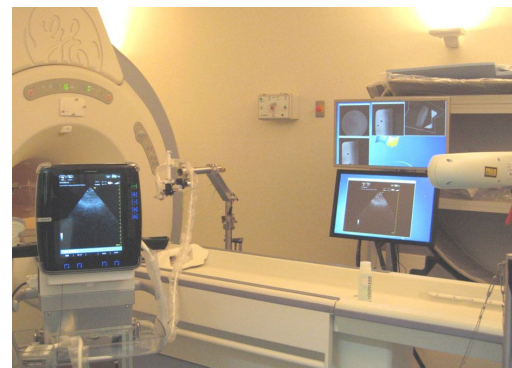
図 2 1.5T MR 装置近傍で動作する超音波装置
