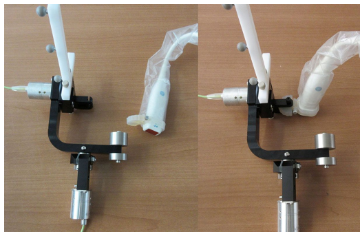
図5 超音波プローブ把持のためのハンドピースの改造。スリットが設けてあり、必要な時には穿刺したままでロボットハンドピースから針をリリースできる。
