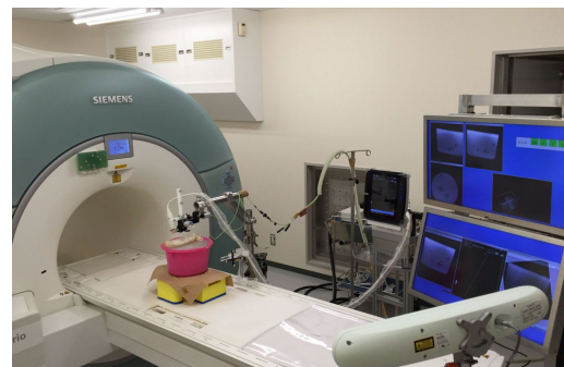
図 3 3T MR 装置近傍で動作する超音波装置
