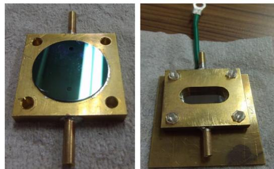
Fig. 1. 電場印加用溶液セル。(左) シリコン板を真鍮セルホルダーに接着した図。(右) 真鍮セルホルダーを挟み合わせた図。
