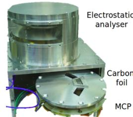
この装置を真空チャンバーに入れて、電子といくつかの種類のイオンを入射して下図に示す結果を得た。データ点の間に見られるカウント差は、異なる入射エネルギーで試験を行ったのと、異なる種類の入射粒子は、異なる強度で発生しているためである。この実験で計測したかったのは、どのくらいのエネルギー以上であれば、検出効率が上がるかという点である。
