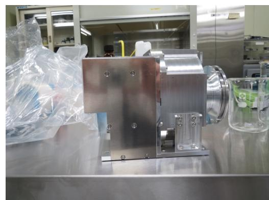
アライザーは電子計測用アライザーとイオン計測用アライザーの 2 つを用意した。本来は 1 台のアライザーで電子・イオンの両方の計測が可能であるが、そのためには正極性から負極性までの高電圧を掃引するための高圧電源が必要となる。本研究の範囲では観測ロケット搭載用の正負両極性掃引電源まで開発する余裕がないことから、高圧電源としては既開発品を用いることにし、その代わ
