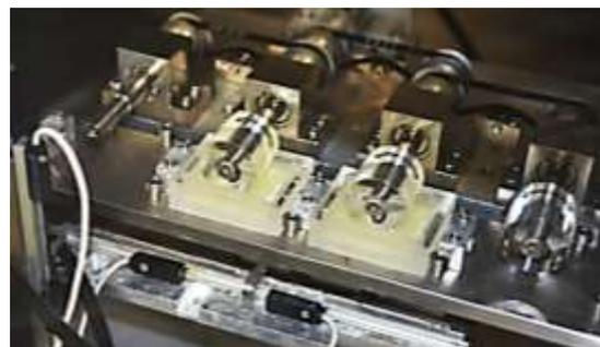
図 1 摺動負荷培養用バイオリアクター外観
