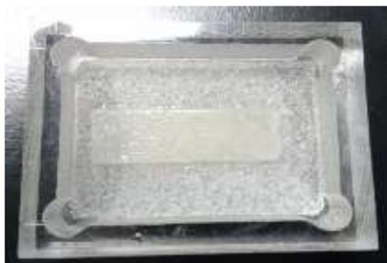
図 2 専用培養皿内に固定された培養組織試験片
