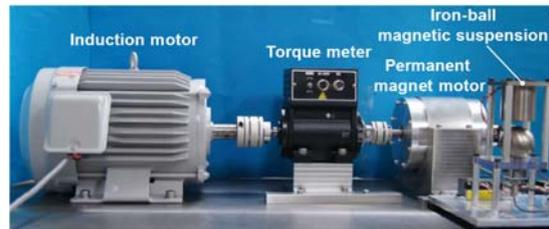
図7 IPM モータと鉄球磁気浮上装置
