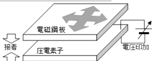
圧電素子による張力印加手法説明図
