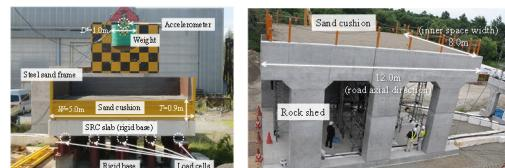
図-2 大型緩衝材実験装置と敷砂緩衝材を設置した実規模ロックシェッド模型
