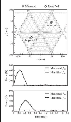
図7 2点衝撃の位置同定・履歴同定結果
