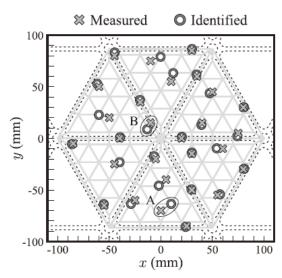
図5 1点衝撃の位置同定結果(変換行列の 作製点数:133)
