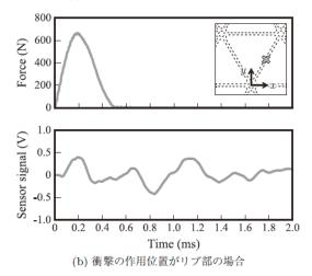
図4 計測荷重およびセンサ応答
