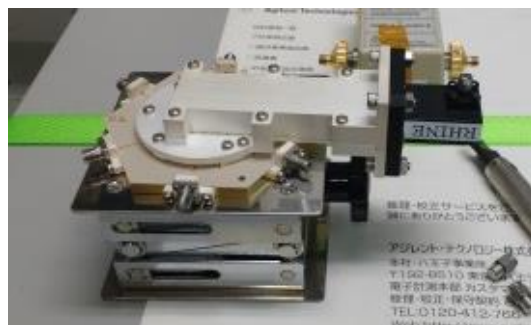
図 3 GaN 増幅器 6 入力円筒導波管電力合成器
