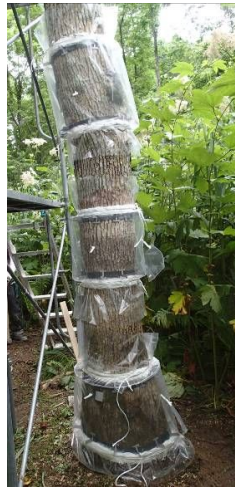
図1 メタンフラックス測定用に製作した2種のチャンバー (左:樹幹用の円筒型チャンバー,右:草本植生用チャンバー)
