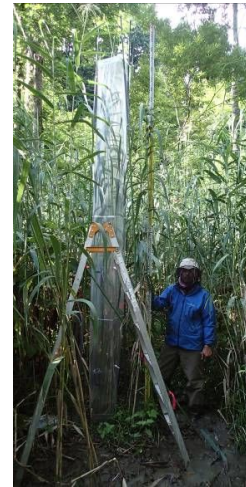
図1 メタンフラックス測定用に製作した2種のチャンバー (左:樹幹用の円筒型チャンバー,右:草本植生用チャンバー)
