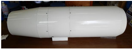
図7. 消音器(全長 1115mm 直径 320mm)
