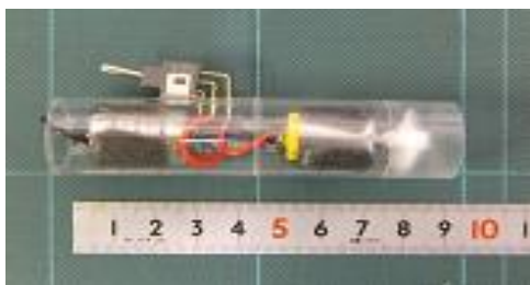
図 12. 簡易浮遊粒子採取器
