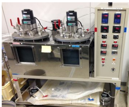
写真2 メタン発酵槽（半連続実験）
