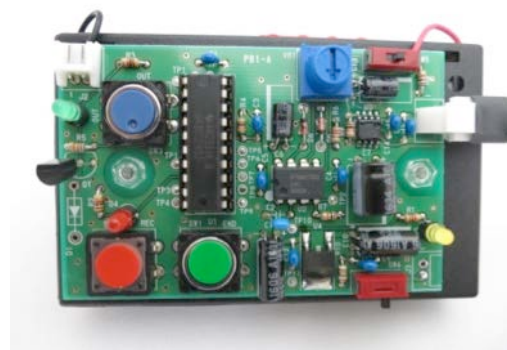
図 5 : 改良版 Programmable Battery
