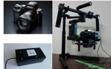
図 8 左上:カメラ、左下:IMU、 右:ジンバルスタビライザー
