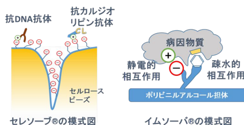
図3 セレソープ®、イムソーバ®の模式図
