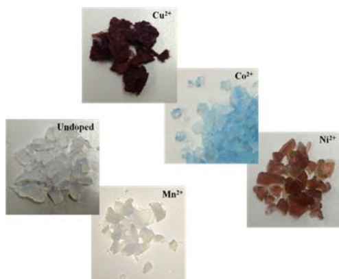
図 4. 各種ドーパント前駆体を含む Silsesquioxane のデジタルカメラ写真
