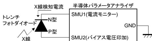
図 8 半導体パラメータアナライザを用いたトレンチフォトダイオードの X 線検知電流の測定方法
