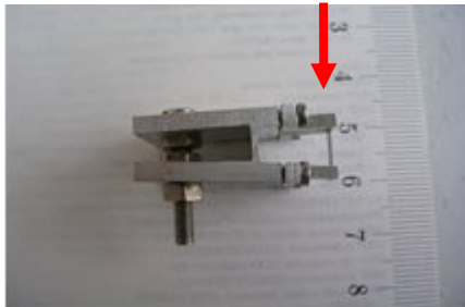
図1：先行研究で用いた湾曲シリコン結晶。矢印のように陽子ビームが入射する。入射ビームの多くがアルミ製ホルダにあたる。
