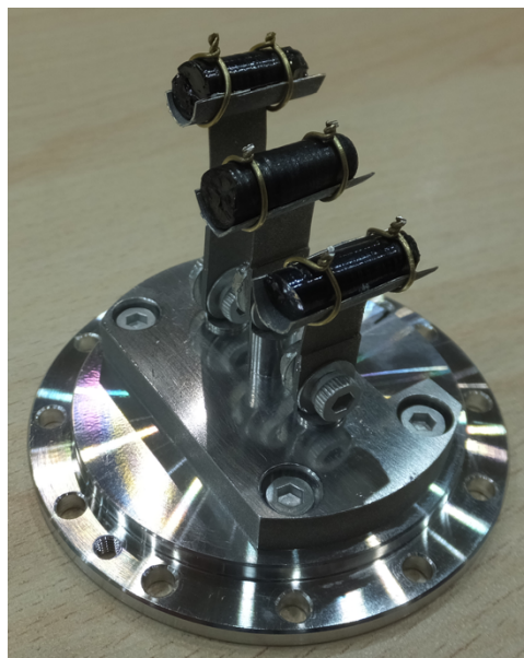
図 1 FZ 法によって育成した単結晶。図は中性子散乱実験用にアルミ治具に固定された状態。
