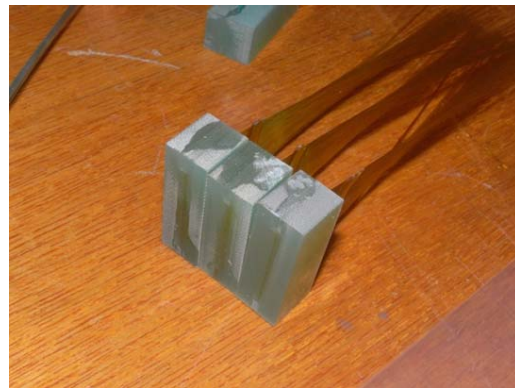
図3. ファイバ素線1000本弱を使ったファイバユニット
