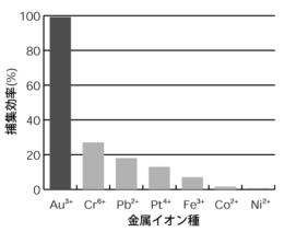
この物質はペプチドとポリエチレングリ コールを組み合わせたブロック共重合体で あり、周辺温度に反応してゾル状態とゲル状 態を行き来するという特性を有している。こ の特性を利用し、攪拌と温度制御のみからな るシンプルなプロセスで金イオンを含有す る水溶液中から金イオンのみを濃縮回収す ることに成功し、特許取得に至った。ただ、 このプロセスはバッチ法であり、一度に大量 の廃水に対して適用しにくいことが弱点で あった。また、水溶液中に混合し、pH を制 御することで金イオンとパラジウムイオン を取り分けるという第2のペプチド材料も開 発したが、こちらもバッチ法での利用しかで きなかった。そこで、この弱点を克服するた めに、貴金属イオンに特異性を示すペプチド 材料をカラム内に固定化し、フロー法での貴 金属イオン捕集を行うことを着想した。
