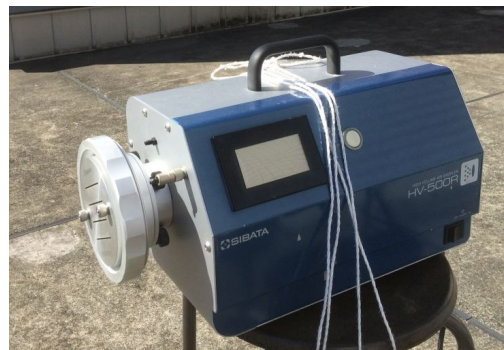
図 2 TiO_2 担持フィルターによる PM_{2.5} の捕集
