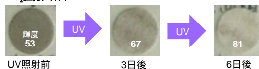
図4 PM 2.5 試料のUV照射に伴う輝度の変化
