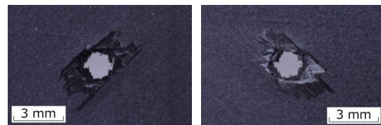
(a) 前面 (b) 後面 照射無し (直径 1.0 mm, 2.41 km/s)
