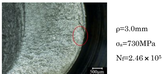
図6 疲労破面に現れたフィッシュアイ
