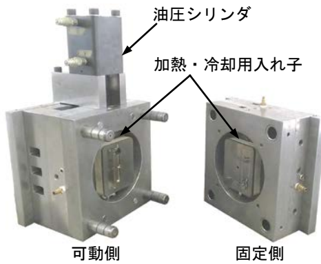
図5 電磁誘導加熱・冷却樹脂流動制御射出成形金型の外観
