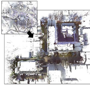
図 6 点群隣接グラフを用いた屋外環境の複数 TLS 点群の位置合せ結果
