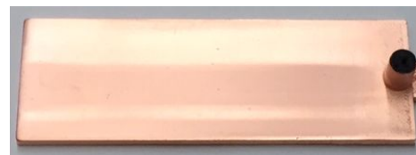
図3 ヒートパイプの表面処理
