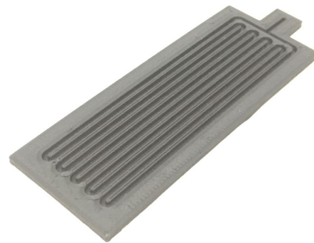
図2 ヒートパイプ内の蛇行流路
