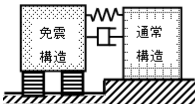
図1 免震+連結制振の概念
