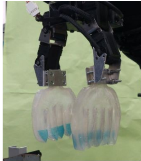
図1 一枚板型のゲルを用いたロボットハンド (文献より引用)
