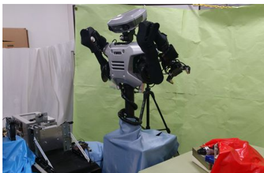
図2 プレス機型の変形装置(写真左側)、片腕にロボットハンドを装着したロボット(写真中央)および温風吹き出し口(写真右側)(文献より引用)
