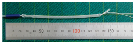
図 2 細径 McKibben 型アクチュエータ (上: 初期状態、下: 300kPa 印加状態)
