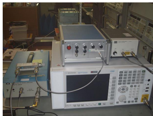
図 4 近傍磁界遮へい量評価システム
