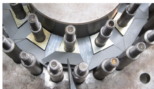
図3. GO分割コア製作専用の治具による分割ピースの設置写真
