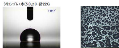
図1. 側面からの接触角の測定と正面からの撥水状態の測定。(前者は撥水性が良い場合の、後者は撥水性が悪い場合の評価に適す)
