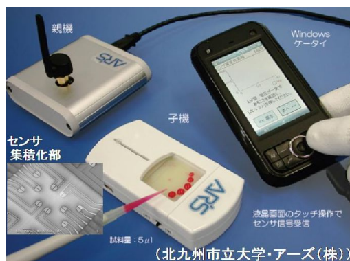
図 1 バイオセンサ素子を搭載した携帯端末
