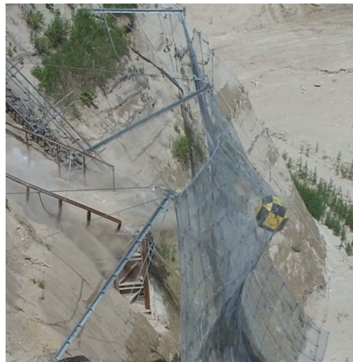
図-1 高エネルギー吸収型ポケット式落石防護網 [1]
