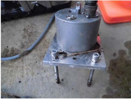
図-5 斜面カップリング治具を取付けた地震計
