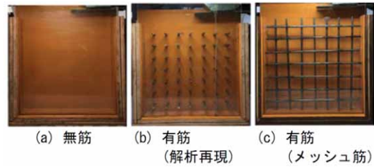
写真-1 小型壁型枠(300×300×50mm)
