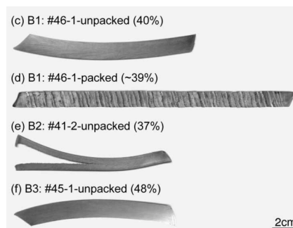
図 1. \text{Ni}_3\text{Al} 単結晶の不整な圧延
